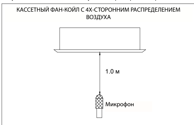
Рисунок №6 Схема испытаний шумовых характеристик агрегатов
