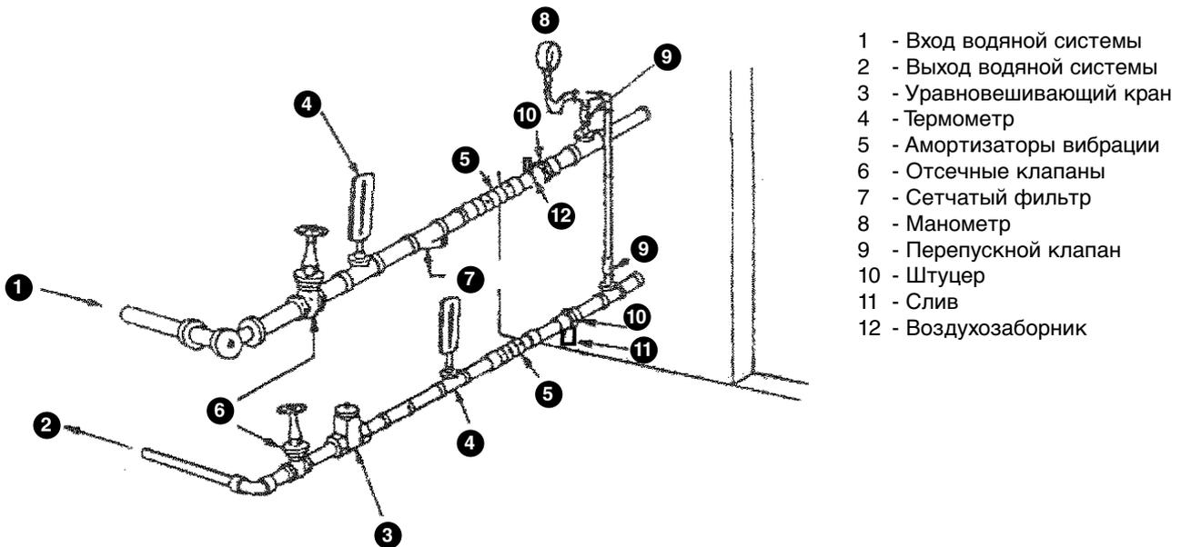
Рис. 1. Типовой контур охлажденной воды - для моделей CGA/CXA
