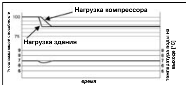
Колебание ELWT (температура воды на выходе испарителя) и бесступенчатое управление производительностью
